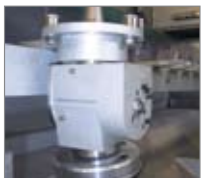
Bevelling aggregate Aggregato per bisellatura Agrédat pour le biseautage Aggregat für Facetten Agregado para biselado
