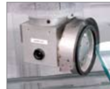
Cup wheel edging Molatura a tazza - Meule boisseau - Toppscheiben Muela de copa
